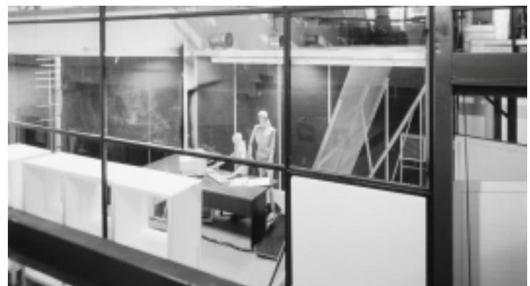
Nos ensaios realizados são efectuadas medições de temperatura, velocidades residuais,... e efectuam-se insuflações com fumo para visualizar com nitidez a distribuição do ar na sala.
