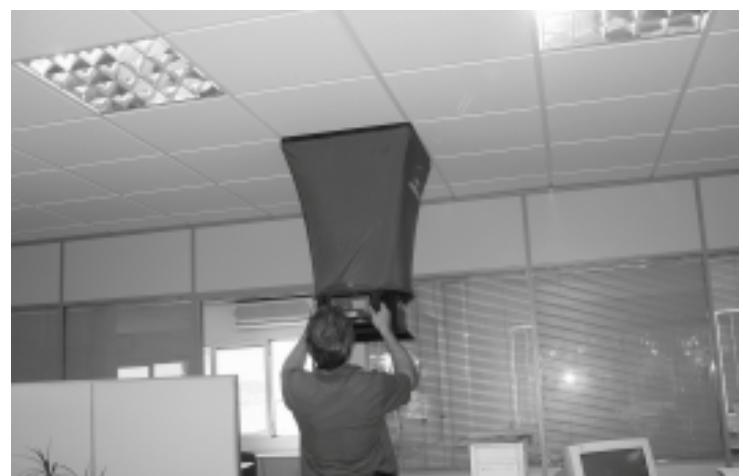
Para efectuar verificações em obra, dispomos de equipamento completo: Balómetro calibrado, sonómetro portátil, anemómetros de molinete e de fio quente, manómetros, etc.
