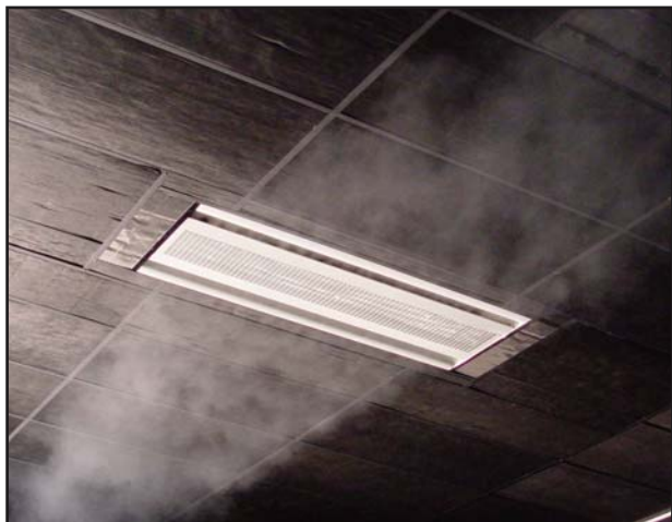
Test aerolique en laboratoire Koolair R&D
