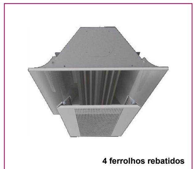
A grelha de indução ou bandeja perfurada frontal podem ser rebatidas 90° accionando pequenos ferrolhos situados na lateral da bandeja ou desmontando totalmente actuando sobre os fechos. Isto permite ter acesso ao interior da viga para a limpeza das superfícies interiores, da bateria e ao sistema de regulação dos bocais.
