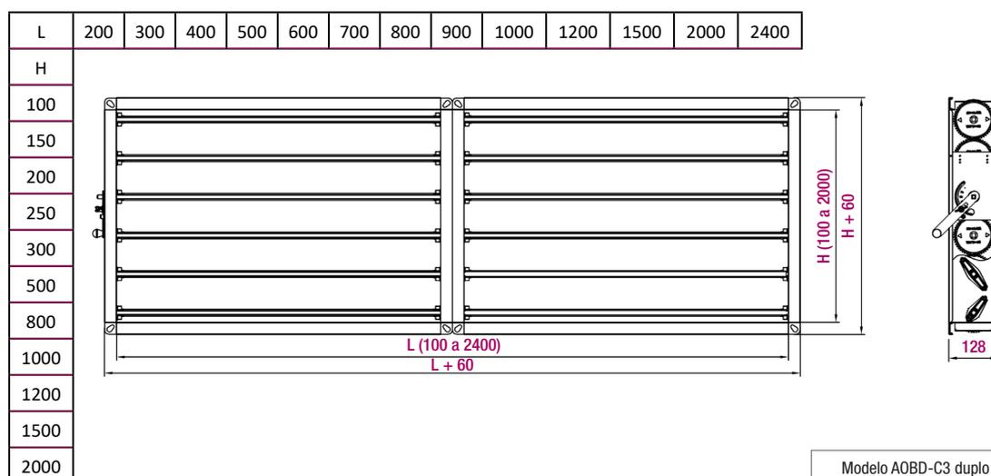
Fabricado em comprimento e altura em escalões de 50 mm.
