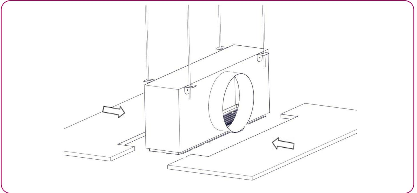
4.1B.4- Une fois les dalles de PLACO sur place, introduire et fixer la grille avec au moins 4 vis à PLACO sur les petits trous Ø4mm. Distance entre vis inférieure à 250mm.
