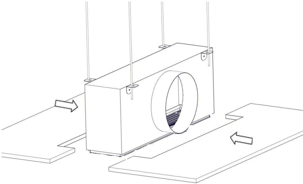
3.4- Fixer la grille avec au moins 4 vis à PLACO sur les petits trous Ø4mm. Distance entre vis inférieure à 250mm.
