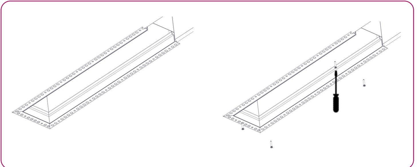
Dans le cas des grilles combinées soufflage/reprise avec des plénums indépendantes la fixation des plénums n'est pas nécessaire. Le plénum sera fixé à la dalle et la grille au PLACO.
