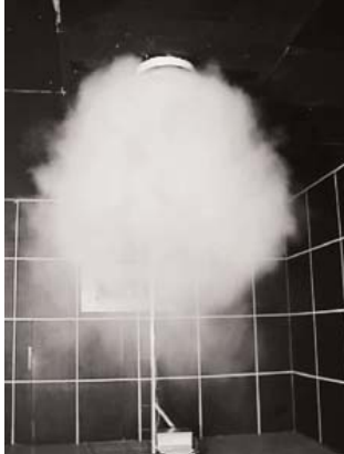
AIRE ISOTERMO ( \Delta T = 0 ) (núcleo central en posición media)
