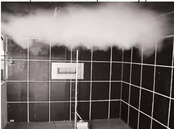
AIRE FRIO ( \Delta T < 0 ) (núcleo central en posición baja)
