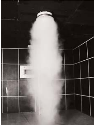
AIRE CALIENTE ( \Delta T > 0 ) (núcleo central en posición alta)
